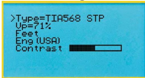
Rápida y fácil configuración de tipo de cable, Vp, pies/metros en pantalla, Idioma y contraste en pantalla.
