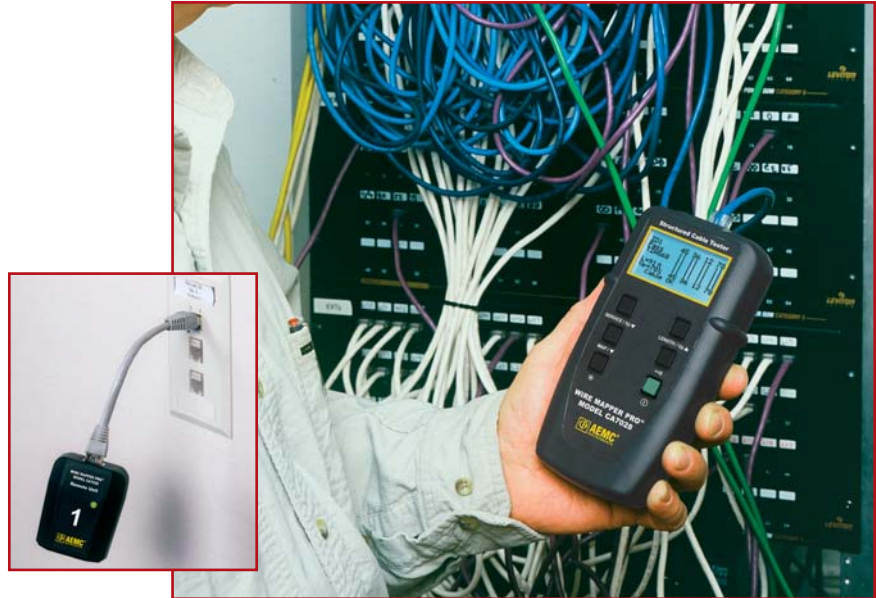
El Modelo CA7028 utilizado para localizar y comprobar un cable desde el panel hasta una oficina localizada a uno ciento de metros de distancia.
