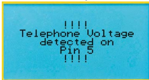
Detección automática de voltaje telefónico.
