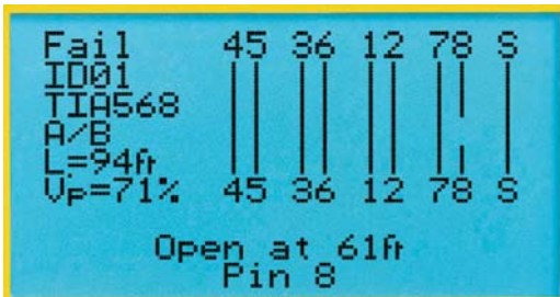
Cable abierto mostrando la clavija y la distancia del punto del fallo
