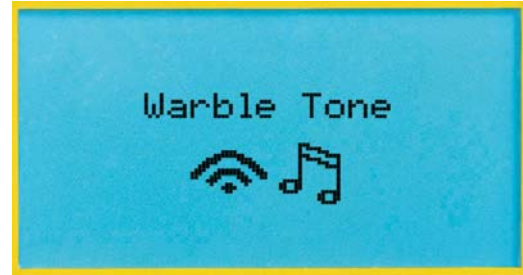
Generador de Tono para el trazado de cables.
