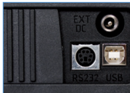
Puertos de comunicación USB y RS232
