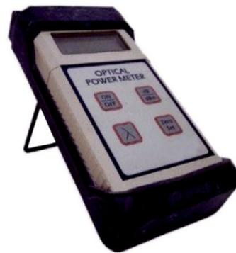
Medidor de Potencia Óptica
