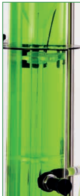
Reynolds experiment - turbulent flow / Experimento de Reynolds: flujo turbulento
