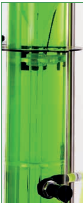
Reynolds experiment - laminar flow / Experimento de Reynolds: flujo laminar
