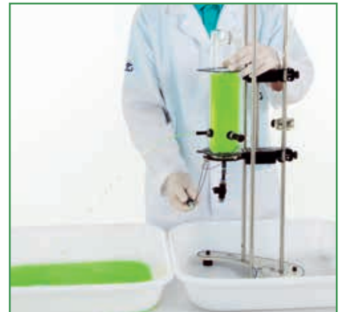
Flow through holes / Caudal por orificios
