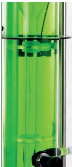
Reynolds experiment - transitional flow / Experimento de Reynolds: flujo intermedio
