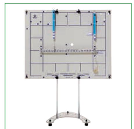
Third class lever (EQ032G) / Palanca interpotente (EQ032G)
